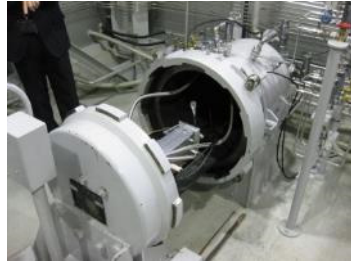
耐圧バッテリーケース (爆発試験風景)
