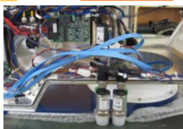
二重化した内圧低下インターロック (圧力センサと保護監視基板)
